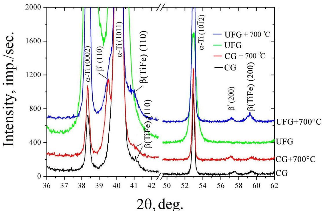
**Рис. S1.** (Colro online) Участок дифрактограмм титана класса 4, свидетельствующие о наличии выделений  $\beta'$  и  $\beta''$  типов. Съемка проведена по схеме гониометра «parallel beam» в режиме на просвет.
