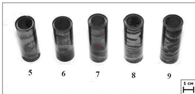
Рис. 2. Фотографии макроцилиндров со стенками из радиально ориентированных МУНТ, полученные в ходе осаждения от 5 до 9 часов соответственно.
